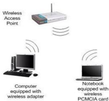
Hình 2-2: Kết nối giữa Access Point và máy tính có hỗ trợ card mạng không dây
